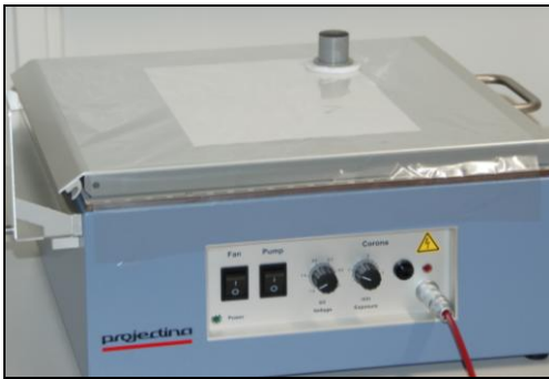
Neue Tonerpad Technik für saubere Entwicklung der Schrifteindruckspuren - das mühsame Auffangen des Kaskadenentwicklers entfällt
