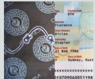
■ Sichtbarmachen von retroreflektierenden Sicherheitsmerkmalen
