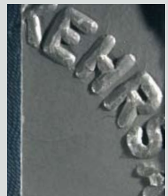
■ Überprüfen eines Prägestempels mit Streiflicht
