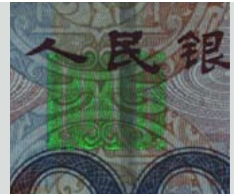
■ Infrarot 740 - 1100 nm Beleuchtung für „Anti-stokes inks“ Untersuchungen
