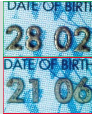
■ Lasergravur Original und Fälschung mit Streiflicht
