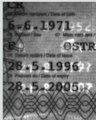
■ Sichtbarmachen von Inhaltsverfälschungen mit IR Lumineszenz
