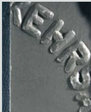
■ Überprüfen eines Prägestempels mit Streiflicht
